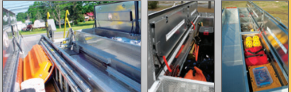
Los compartimientos del techo pueden ser diseñados para almacenar equipo específico. El piso es elevado para permitir el drenado. Las tapas se mantienen abiertas con resortes neumáticos.
