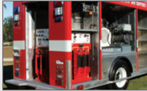
Producción móvil de oxígeno con compresores de 14-65 CFM y una o múltiples estaciones de abastecimiento.
