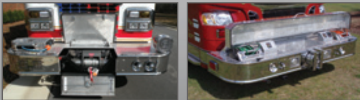
Algunas configuraciones incluyen enrolladores eléctricos de cable, enrollador de mangueras hidráulico o de aire, herramientas de poder pre-conectadas o cabestrantes portátiles.
